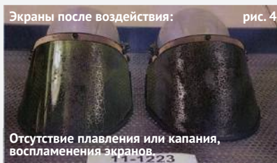
Отсутствие плавления или капания, воспламенения экранов.
