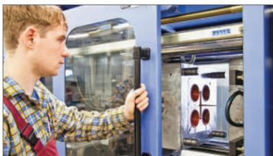
Термопластавтоматы для производства литых изделий
