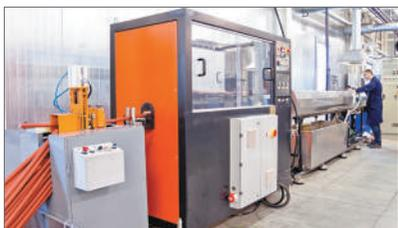
Линии для экструдирования термоусаживаемой трубки
